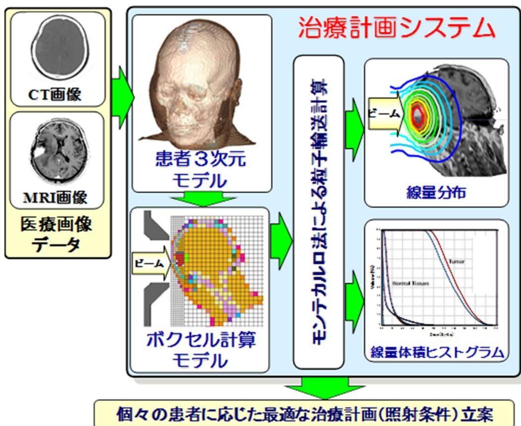
図 3-2 BNCT 用治療計画システムによる線量評価の流れ
