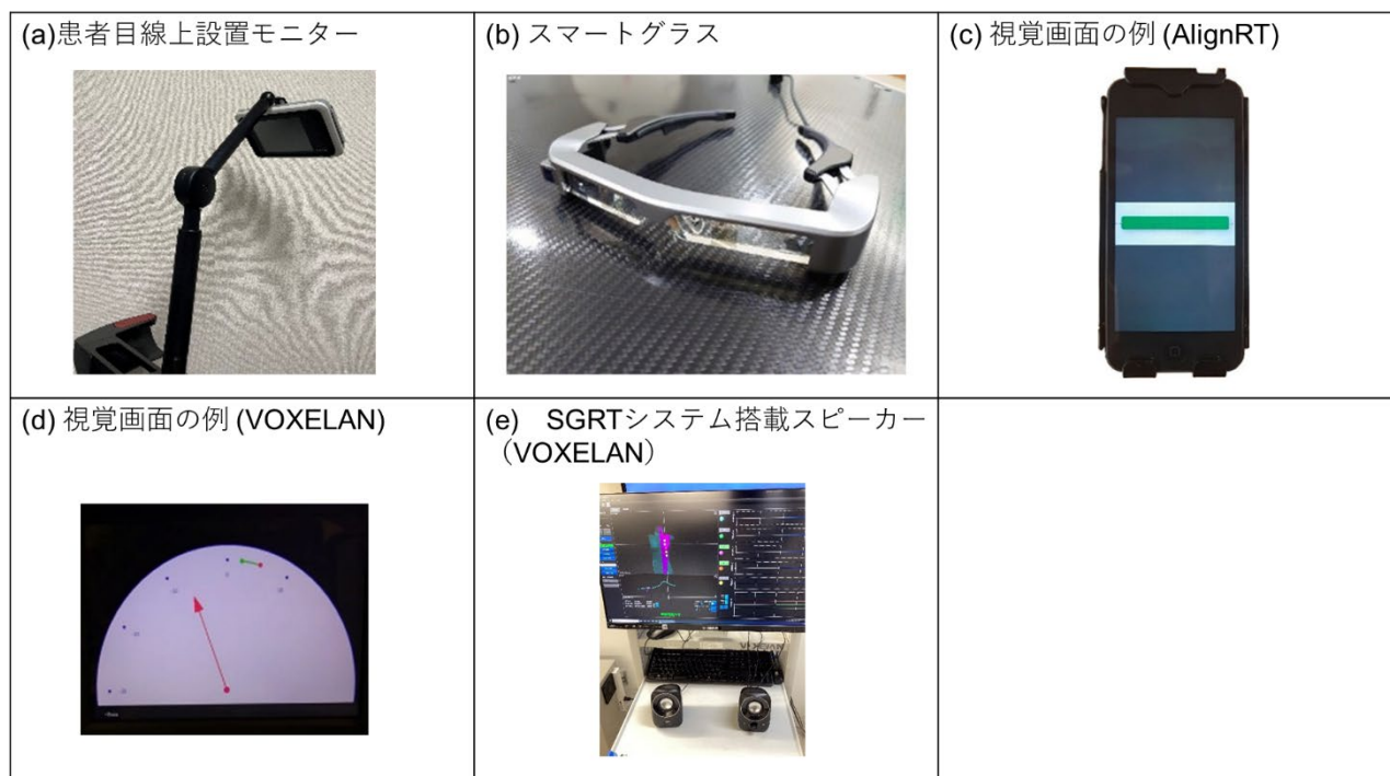
図 8: SGRT に使用される Audio-visual フィードバックの例((a)患者目線上設置モニター, (b)スマートグラス, (c)視覚画面の例 (AlignRT), (d)視覚画面の例 (VOXELAN),(e)SGRT システム搭載スピーカー(VOXELAN))
